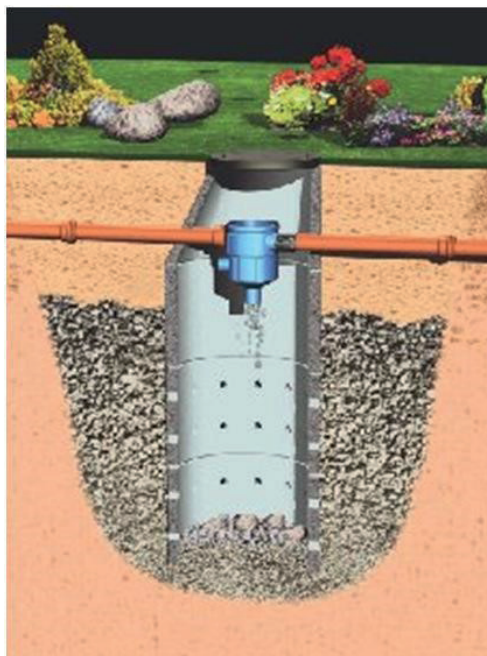
Ілюстрація 66: будова і принцип дії каналізаційного колодязя
